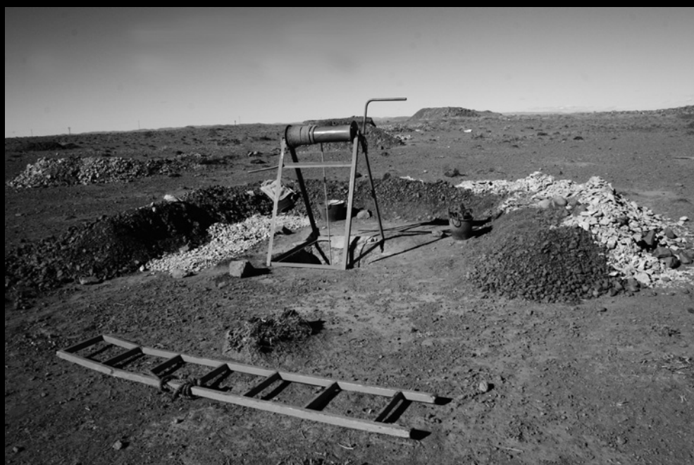
Attrezzi e strutture utilizzati per l'estrazione. Gli scavi sono ancora eseguiti con piccone e pala
