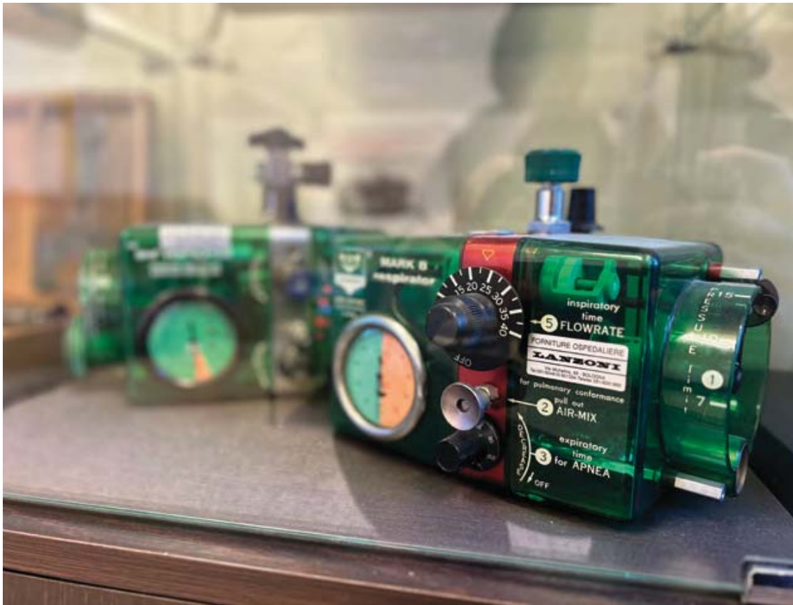
Respiratore universale a pressione positiva e negativa Bird modello Mark 8 (seconda metà anni '60)
